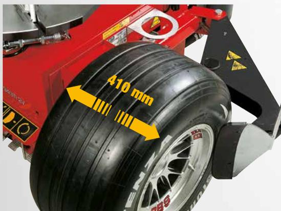
Le bras détalonneur permet une ouverture jusqu'à **410 mm**, et il est équipé d'un régulateur de course pour éliminer la possibilité d'écrasement du pneu. Le détalonneur est actionné par un vérin pneumatique à double effet entièrement réalisé en **acier inox** qui développe une puissance de **15500 N** sur la palette.
