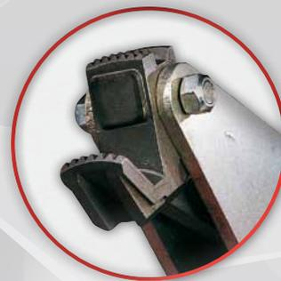
**Morsa idraulica autocentrante** con capacità da **14" a 26"**, dotata di valvola di ritegno che **evita la chiusura accidentale**. Per **evitare graffi sui cerchi in lega leggera** sono disponibili sia le protezioni per l'autocentrante che gli anelli adattatori.
