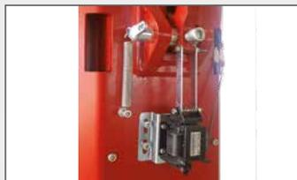
Sblocco sicure con **elettromagnete 24V.**
