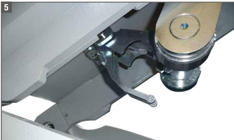
**5.** Dispositivo a “**coccodrillo**” come fermo di sicurezza per fermare il movimento del sollevatore in caso di eccessivo disallineamento tra lato sinistro e destro (non è più necessario l’occhio elettrico).
