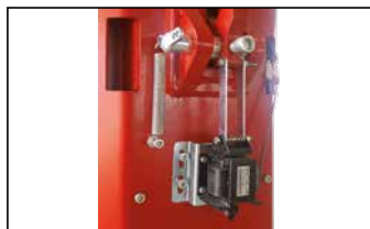
Desbloqueo seguros con electroimanes 24V .
